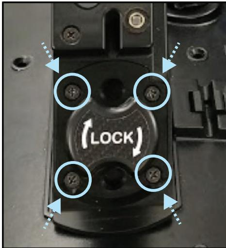
7. Mantenere l'unità di bloccaggio in posizione e rimontare le quattro viti. Serrare ciascuna vite con precisione.
