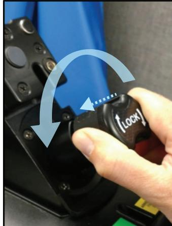
1. Spingere la manopola verso il basso e ruotarla in senso antiorario di 360 gradi finché smette di ruotare. (La manopola di bloccaggio si estenderà verso l'esterno)
