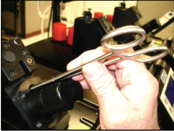
5. Posizionare la nuova unità di bloccaggio sopra i dischi. Allineare i dischi ai fori forniti nell'unità HEX utilizzando una pinza emostatica per allentare la pressione delle molle.
