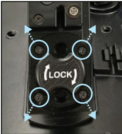
2. Rimuovere le quattro viti che fissano l'unità di bloccaggio al blocco ESAGONALE. Rimuovere l'unità di bloccaggio.
