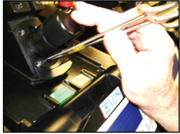
6. Premere leggermente l'unità di montaggio in posizione mantenendo entrambi i dischi allineati. L'unità di bloccaggio deve essere collocata orizzontalmente sulla parte inferiore dell'unità dello scambiatore di calore. I dischi devono essere posizionati contro le guarnizioni a disco.
